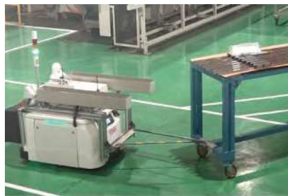
連結台車牽引
